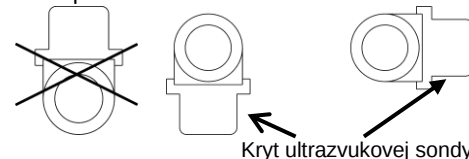
Obr. 6: Odporúčaná montážna poloha pri meraní chladu
